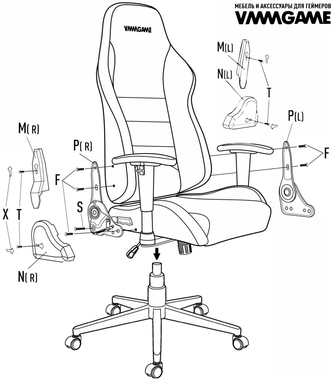
\*Перед установкой газлифта, снимите защитный колпачок (если он имеется).
