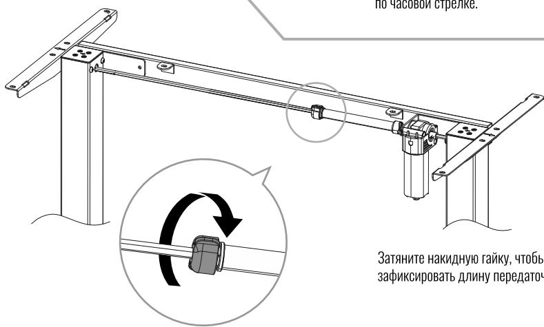
Затяните накидную гайку, чтобы зафиксировать длину передаточной тяги.
