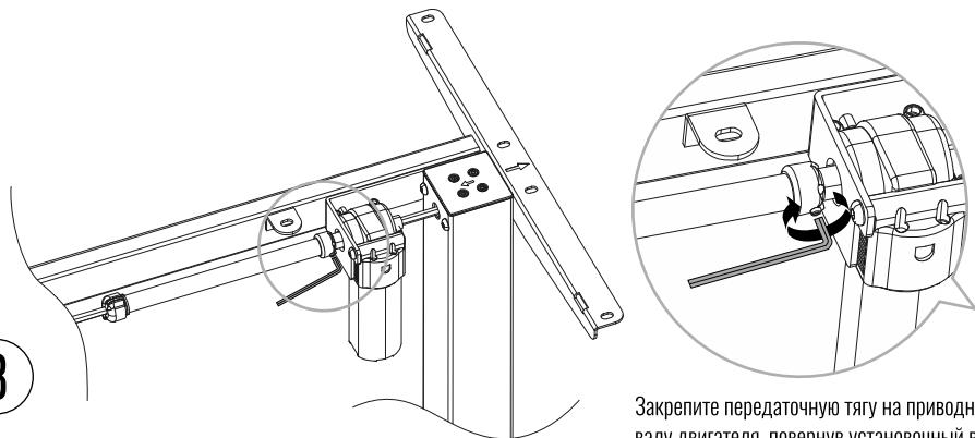
Закрепите передаточную тягу на приводном валу двигателя, повернув установочный винт по часовой стрелке.
